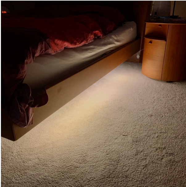
Onder de rand van het bed zit een ledstrip die automatisch aan gaat als er beweging wordt gedetecteerd. De sensor kan ook in een detectormat zitten.
